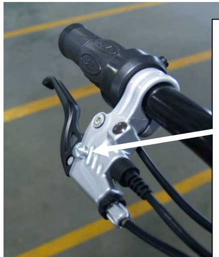
Frein parking de la roue avant fixé
