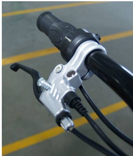
Frein parking de la roue avant non fixé
